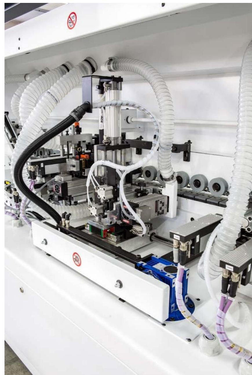
● Gruppo arrotondatore A-PR02 a 1 motore HF a 12.000 g/1' per la lavorazione degli spigoli.
